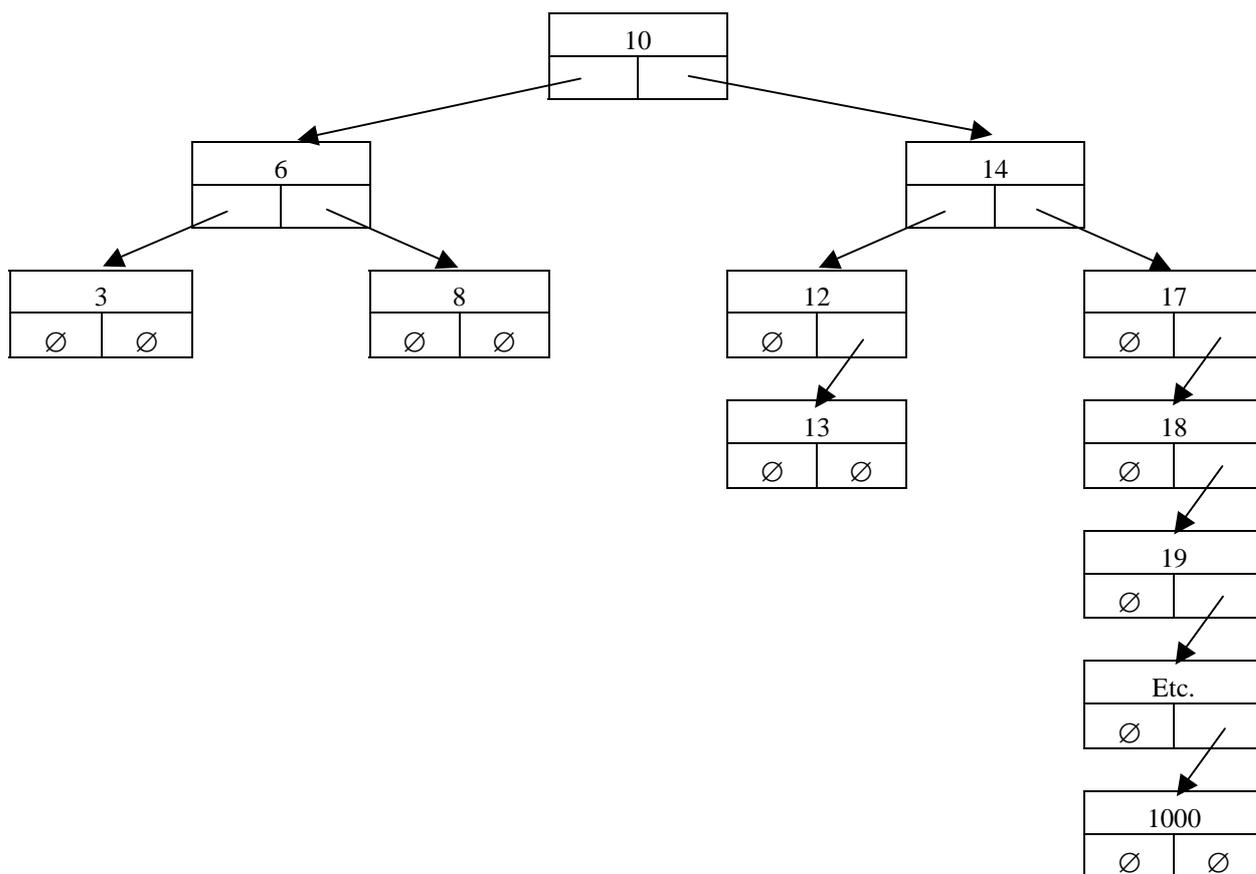
Autrement dit, l'arbre binaire se transforme en liste chaînée. De ce fait, la recherche de la valeur 1000 dans un tel arbre se fera en presque 1000 tests.
